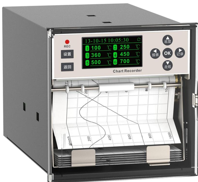
KRM 系列是一款设计先进、品质优良的工业有纸记录仪，广泛应用于生产、实验、测试等过程工艺参数曲线记录打印，实时采集各种传感器输出信号，如温度、压力、液位、流量、PH 值、电导、溶氧等，支持信号类型电流 (mA)、电压 (mV/V)、热电阻、热电偶等。
